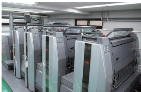
1台目として導入した、LED-UVと印刷品質検査装置PQS-D(I)を搭載したRMGT 940ST-4(1台目)
