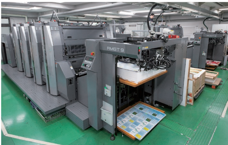
LED-UVを搭載したA全判4色機RMGT 940ST-4が2台並ぶ
